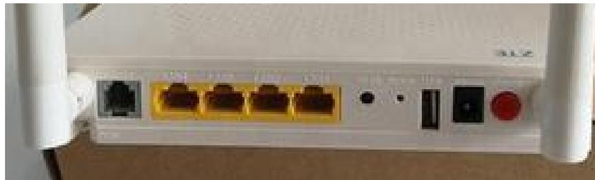
Vista trasera: RJ11, 4 x RJ45, Reset, USB, Fuente y Enc.
